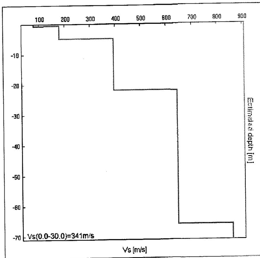
Figura 6: grafico per il calcolo delle VS30
